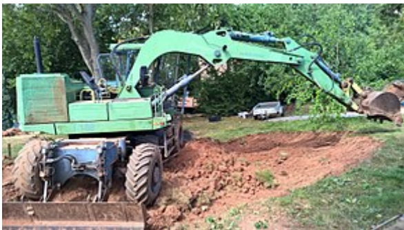
Weimar T 188 Bagger in der Version A03 (mit Abstützpratzen und Schiebeschild) mit dem sehr selten verbauten Monoblockausleger
