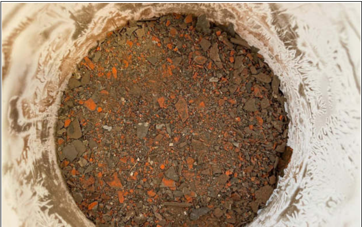
Abbildung 1: Probe 20, Farbanstrich, Stahlkonstruktion, EÜ Kornwestheim
